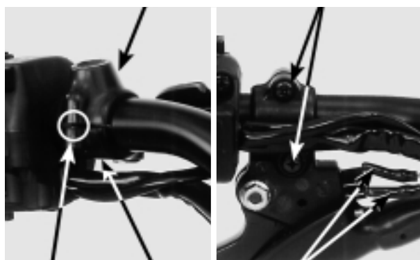
ALINHAR SUPORTE CONECTORES DO INTERRUPTOR DA EMBREAGEM ESPELHOS RETROVISORES
