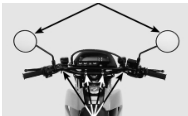
BRAÇADEIRAS DA FIAÇÃO BRAÇADEIRA DA MANGUEIRA DO FREIO
