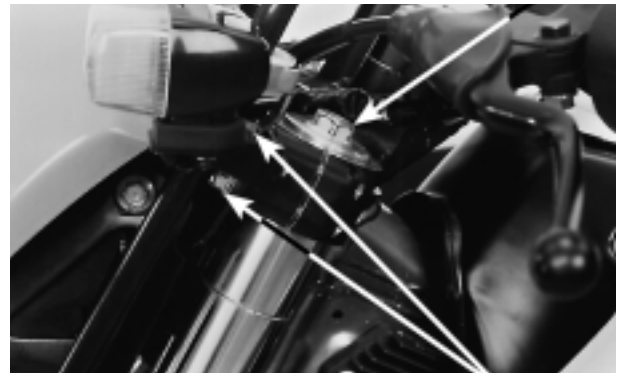
PARAFUSOS DE FIXAÇÃO DA MESA SUPERIOR PARAFUSOS
