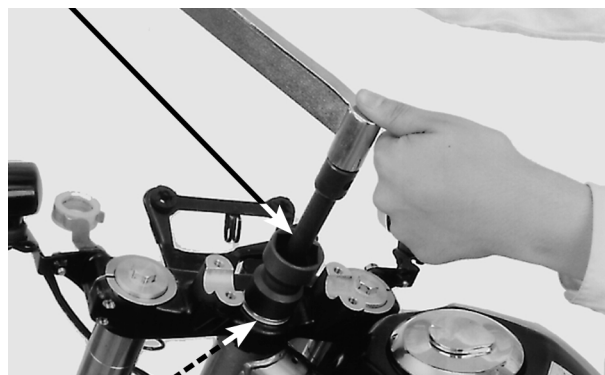
PORCA DA COLUNA DE DIREÇÃO
