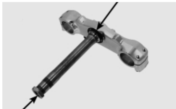
PORCA DA COLUNA DE DIREÇÃO
